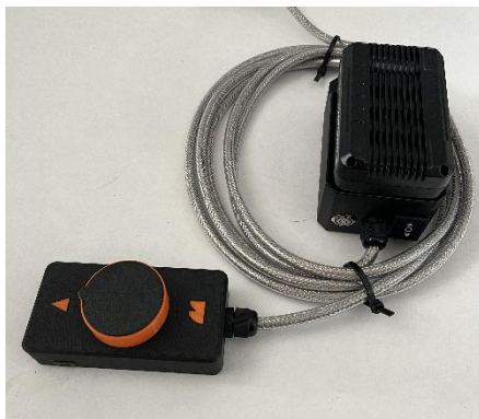
Bedieneinheit mit Drehknopf und Akkueinheit mit Hauptschalter und Aufstellschalter
