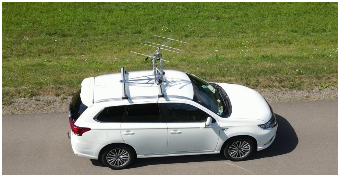
CAR mit unserer Yagi 4-Element Antenne im Einsatz
