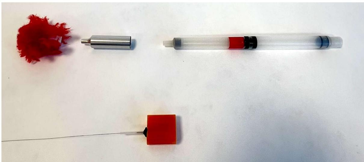
Unser Sender wird in einer kleinen roten Box in einer Plastikverpackung geliefert – auf der Verpackung ist die Frequenz des Senders angegeben. Stellen Sie Ihren Empfänger auf diese Frequenz ein. Wenn Sie einen Empfänger im USB-Modus verwenden, denken Sie daran, dass Sie unterhalb der angegebenen Frequenz bleiben müssen.
