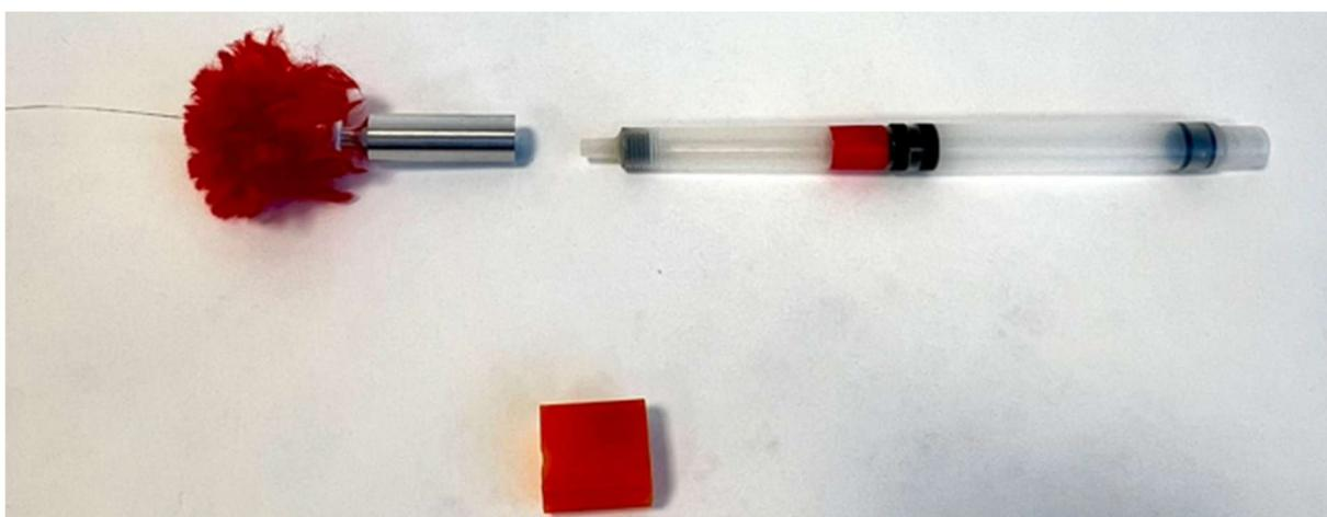
Befestigen Sie den roten Stabilisator und stellen Sie sicher, dass die Antenne des Senders nicht blockiert ist.
