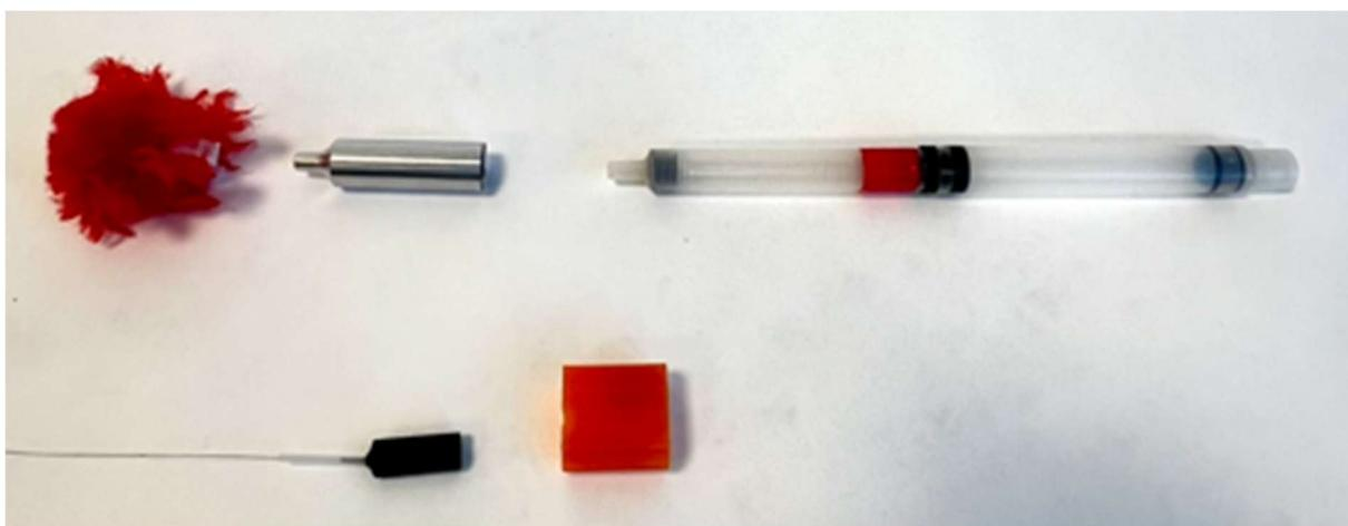
Der Sender wird durch Entfernen der roten Gummikappe aktiviert. Nun ist es an der Zeit, die Frequenz des Senders mit allen Empfängern zu überprüfen, die ihn verfolgen werden. Jeder Empfänger kann eine Abweichung aufweisen. Stellen Sie das beste Signal ein und notieren Sie es für alle Empfänger.
