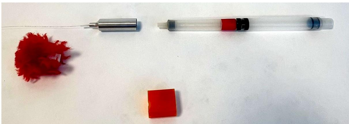
Setzen Sie den Sender wie auf dem Bild oben gezeigt in das Aluminiumrohr (SG-k) ein. Achten Sie darauf, dass die Antenne des Senders nicht blockiert ist.
